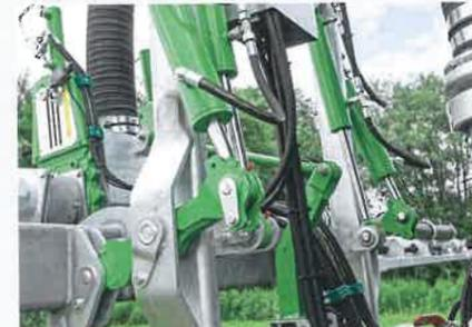
Zwei zusätzliche Zylinder drücken den Gestängebalken per Kipphebel vor dem Einklappen hoch.
