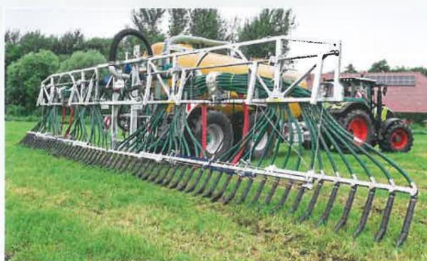
Drahtseile ziehen die Ausleger hoch in die Tropfstopp-Position. Die frei schwingenden Ausleger erzeugen wenig Druck pro Kufe.
