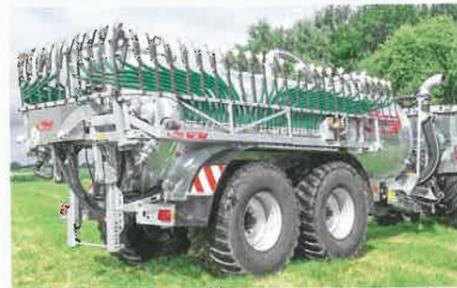
Das Gestänge ist fest angebaut. Die Schwenkzylinder heben das Gestänge aus der Transportposition.
