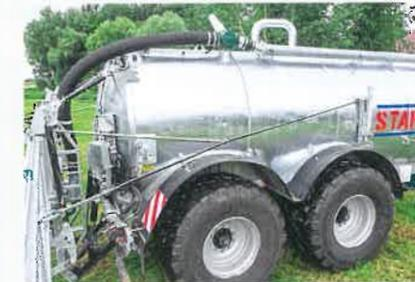
Stapel stützt die Ausleger mit zusätzlichen Drahtseilen. Die Vierpunktkopplung am Fass ist stabil.
