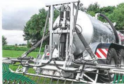
Über Winkelsensoren im Drehpunkt drosselt Fliegl die Klappgeschwindigkeit am Ende.
