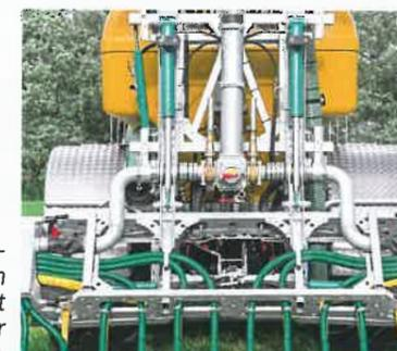
Wie bei einem Spritzgestänge gibt es ein zentrales Pendel mit hydraulischer Abstützung.
