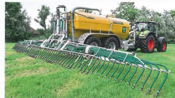
Das GlideFix klappt sehr schnell aus und ein. Die oberen Lenker heben das Gestänge aus der Transportposition.
