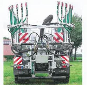
Die Gestängeenden werden zur Mitte geschwenkt, damit der Überhang reduziert wird.
