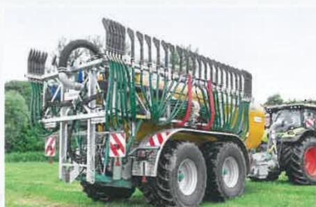
Der Überhang nach hinten ist minimal, allerdings ist die Transportbreite vergleichbar groß.
