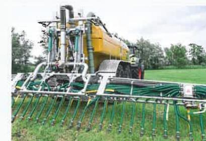
Zwei doppeltwirkende Zylinder klappen das Gestänge.
