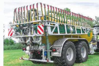
Das Gestänge schmiegt sich eng an das Zunhammer-Fass an.
