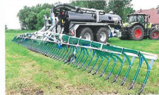
Der Farmer klappt in nur 25 s in die Arbeitsposition. Mit den Stützrädern liegt das Gestänge stabil, auch bei höheren Geschwindigkeiten.
