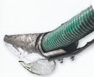
Kufe und Tülle sind aus Stahl und bilden eine Einheit.
