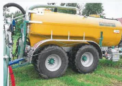
Zusätzliche Drahtseile stützen das Gestänge in der Arbeitsposition.
