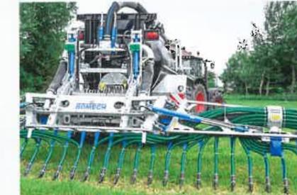
Zwei dw-Zylinder schwenken das Gestänge. Langlöcher gewährleisten die Bodenanpassung.
