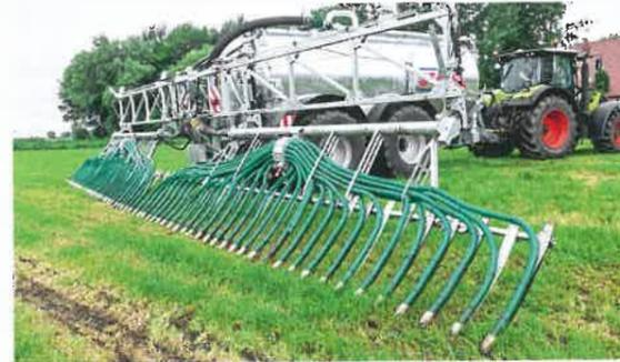
Das ProGreen ist starr mit dem Fass verbunden. Der Auflagedruck der Schuhe kann hydraulisch variiert werden.
