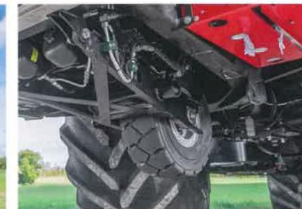
Mit Stützrad vorne unter der Kabine und hinten am Schwenkhubwerk liegt der neue Terra Variant stabil auf der Straße und darf als Dreiachser bis zu 24 t wiegen.
