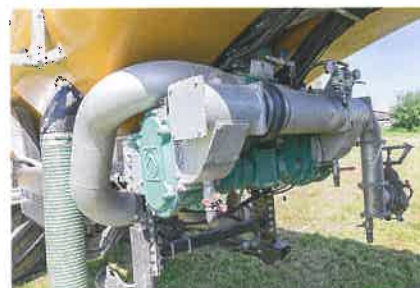
Zunhammer setzt auf eine Tandempumpe mit je 4 m 3 Leistung. Fotos: Bensing
