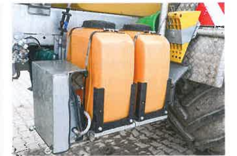
200 l Nitrifikationshemmer werden in den Tanks gebunkert und automatisch dosiert.
