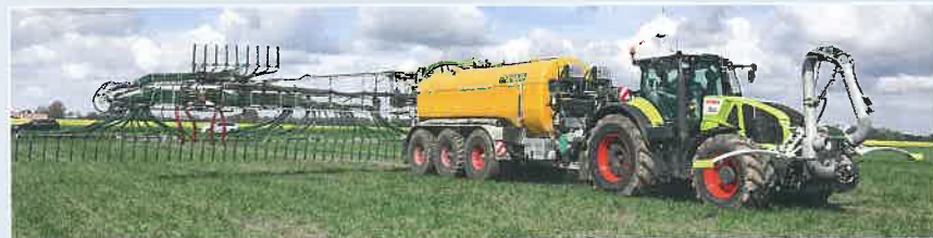
Der Isaria-Sensor im Fronthubwerk ermittelt die notwendigen Daten zum Stickstoffbedarf der Pflanzen, der über die variabel ausgebrachte Güllmenge gedeckt wird.
