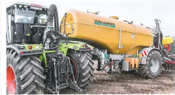
Man ist mit dem Auflieger extrem wendig. Zudem hinterlässt der Einachser keine Spuren.
