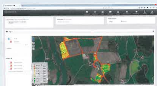
Der NIRS-Sensor in Verbindung mit den Geo-Daten vom Xerion ermöglicht eine automatische Nährstoffdokumentation.
