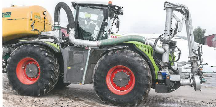
Der 8-Zoll-Saugarm ermöglicht eine schnelle Füllung. Die Kreiselpumpe im Arm drückt die Gülle zu den beiden Drehkolbenpumpen.
