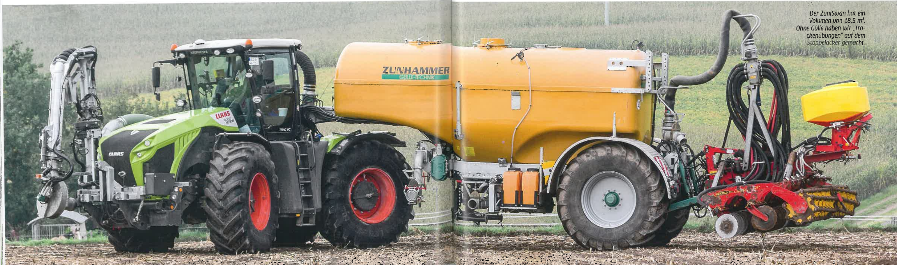
Die hydraulisch gefederte Achse stammt von FAD. Der Zuni-Swan ist 3 m breit.
