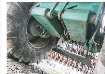
Die hydraulisch gefederte Achse stammt von FAD. Der Zuni-Swan ist 3 m breit.
