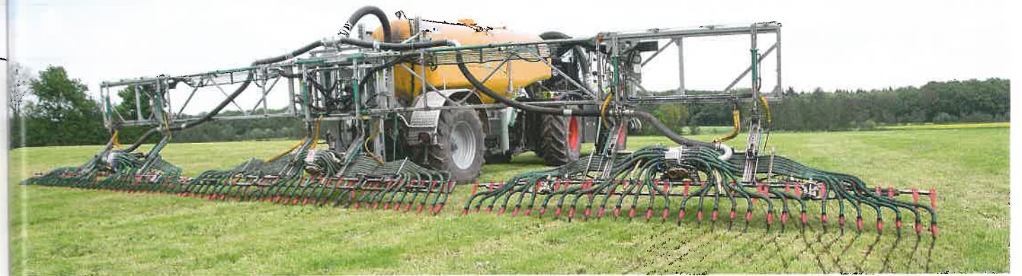
Breite Gestänge wie dieses 21-m-Schleppschuhgestänge können seitlich geklappt werden.
